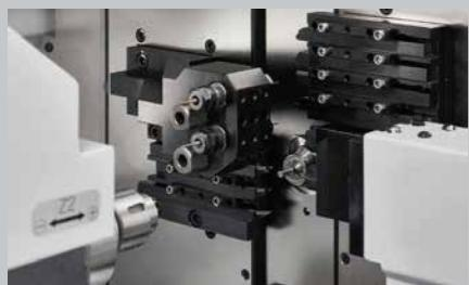
最大加工径Φ1mmの「R01」とΦ4mmの「R04」をラインナップしている「Rシリーズ」より「R04VI」を出展。微細加工に適した切削速度を実現する最高回転数20,000 min-1の主軸、ガイドブッシュベース一体化構造で熱変位を抑える刃物台、リニアモーターとサーボモーターを組み合わせた適材適所
