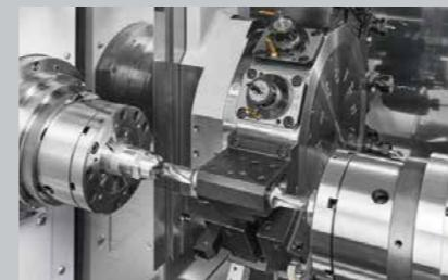
BNJとの共通モジュールを採用した2主軸1タレット機。正面・背面共に最大加工径Φ51mmの「BNX51MSY」と、正面の最大加工径をΦ65mmに拡大した「BNX65MSY」をラインナップ。JIMTOF2024には「BNX51MSY」を出展。系統間同期制御による重複加工や「LFV(低周波振動切削)技術<sup>\*1</sup>」に
