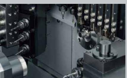
「L12」は最大加工径Φ12mmの小径加工用自動旋盤です。高速主軸を搭載し、高い生産性と精度を実現。幅1,760mm×奥行き820mmのコンパクト設計で、B12など既設の小径加工機から高機能な5軸加工機への更新にも最適です。簡単な手順でガイドブッシュ・ガイドブッシュレスの段
