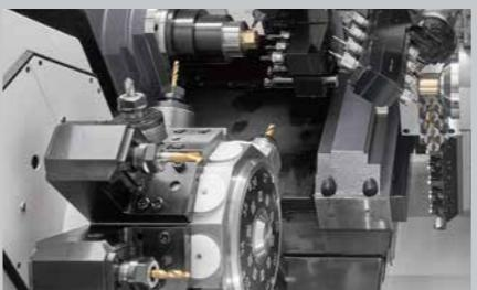
シンコムブランドの最上位機種「Mシリーズ」より「M32VIII」を出展します。最大加工径はΦ32mm。くし刃とタレットを組み合わせ、多様な複合加工への対応や高い生産性を実現しています。JIMTOF2024では、回転工具を用いてねじ切りをおこなう「スレッドワーリング」の加工時間を短縮する
