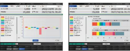
**ECO画面:**操作盤画面上に消費電力量や油脂類の消費量、エア消費量、CO<sub>2</sub>排出量を可視化
