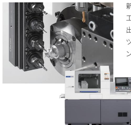
新しいL20は、シチズン独自の「LFV（低周波振動切削）技術」が正面・背面加工ともに使用可能になり、ダウンタイム軽減に貢献します。また、背面主軸の高出力化により加減速度が向上したことによりサイクルタイムを短縮。くし刃旋削ツールの最大取付本数を6本とすることで、ツール不足を解消しました。ハイエンドモデルのL20XIB5は、同時5軸制御に対応しCAMと連携することで複雑形状加工が可能です。
