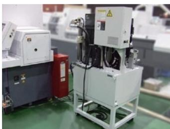
多系統対応高圧クーラント装置
