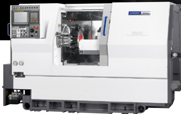
独自形状である第2刃物台のツール取付面数を6から8ポジションへ増加、回転工具の取付も可能になりました。工程分散によるサイクルタイムの大幅短縮、より複雑な加工に対応。第1刃物台の回転工具は20Nmから25Nmへトルクアップし、より強力な切削が可能になりました。操作盤の配置を見直し、ドア開口部を大きく取る事で段取り時の作業性を大幅に改善、作業者への負担を軽減。シチズンの定める環境配慮型製品とすることで環境負荷の低減にも貢献します。
