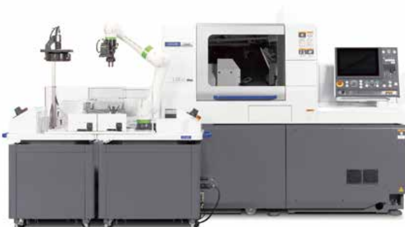
オンカートタイプA ハンドシェイク (L20への接続例)
