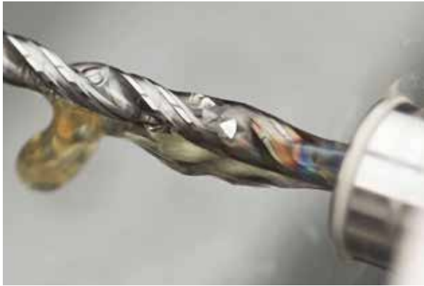
オイルホールドリルによる深穴ドリル加工。 分断された切屑がドリルの溝を通して排出されるため、切屑がらみの心配がありません。
