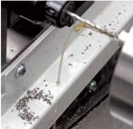
オイルホールドリルによる深穴ドリル加工。 分断された切屑がドリルの溝を通して排出されるため、切屑がらみの心配がありません。
