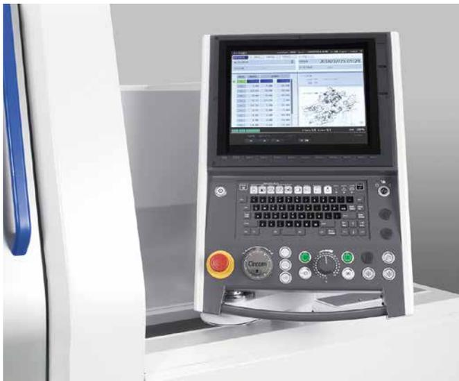
新HMI (ヒューマン マシン インターフェイス) 搭載の操作盤には、15インチのタッチパネルを採用し、作業者の機械操作性を向上しました。
