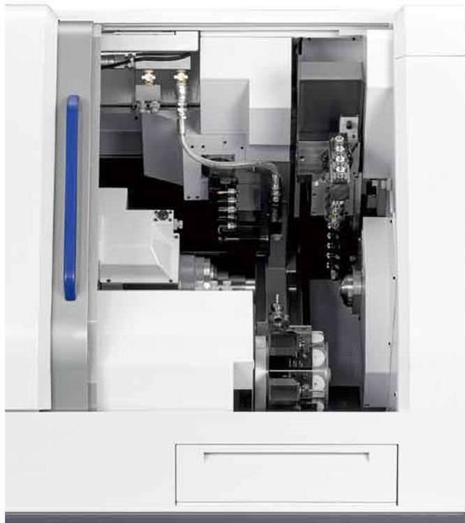
ドアの大きさを従来機の165%に拡大し、作業効率アップしました。また、窓の大きさも拡大することによって、ドアを閉めた時の視認性も向上させています。
