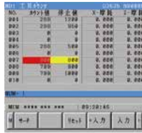
工具カウンタ カウンタの停止位置設定及びリセット、工具摩耗補正の入力。
