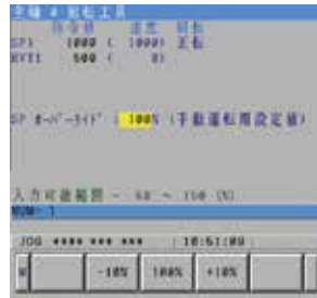
主軸&回転工具 主軸・回転工具の回転速度設定。 スピンドルオーバーライド設定。
