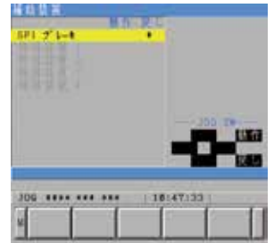
補助装置 ブレーキ等、補助装置を手動操作する際に装置を選択。
