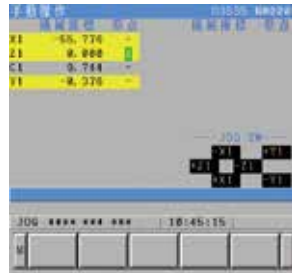
手動操作 各軸の原点ランプ状態・機械座標表示。
