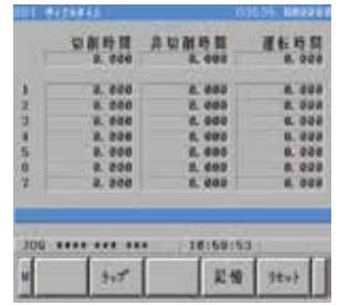
サイクルタイム表示 1サイクルの切削時間・非切削時間・運転時間の測定。
