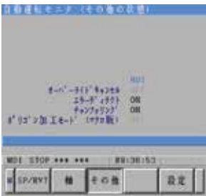
自動運転モニタ 各軸の制御状態を表示。 マシンロックのON/OFF。
