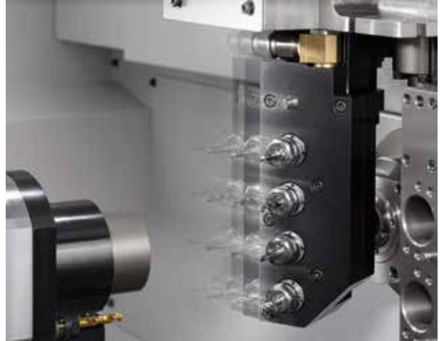
IX、XII型のくし刃刃物台回転工具にはB軸を標準搭載しており、90°~45°まで135°の範囲で設定可能です。
