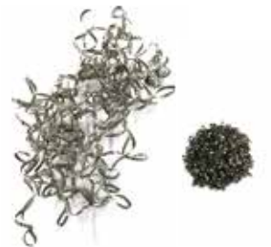
慣用切削による切屑 LFVによる切屑
