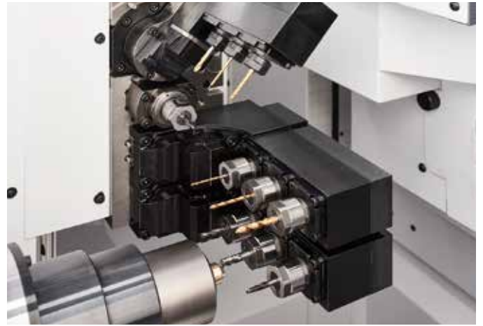
独立した背面刃物台による背面加工
