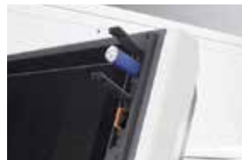
USBスロットとSDカードスロット SDカードからプログラムを呼び出して運転することが可能です。
