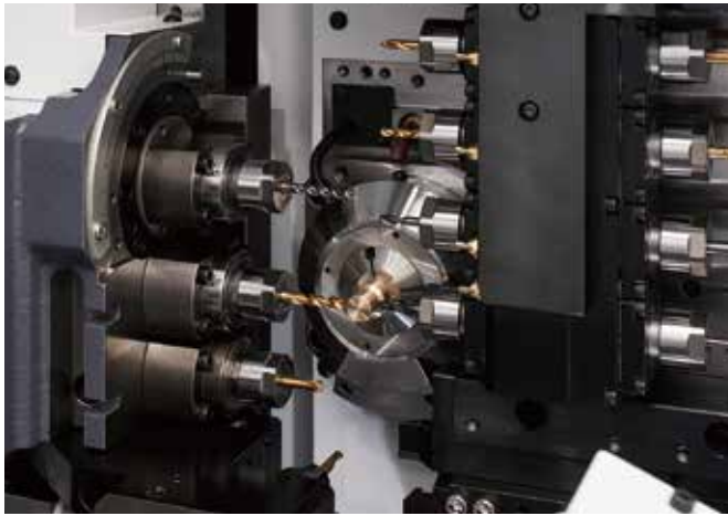
正面加工2工具同時加工
