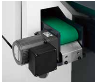
パーツコンベア 棒材加工では必須オプションです。
