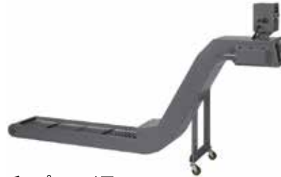
チップコンベア ヒンジ式コンベアは切屑をスムーズに排出する装置で長時間無人化運転を行う場合に必須のオプションです。
