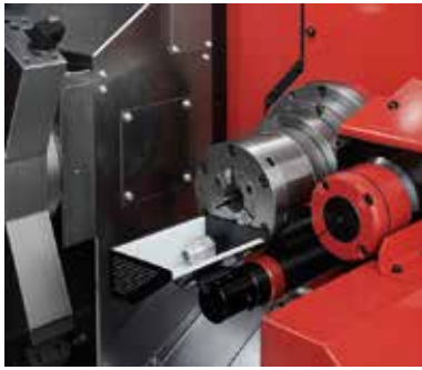
パーツキャッチャー 棒材加工では必須オプションです。
