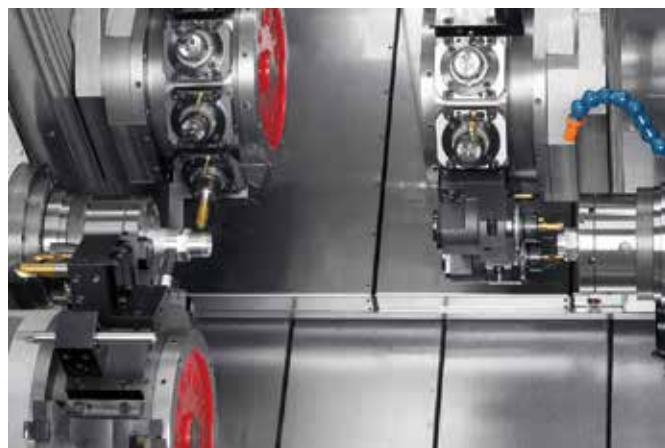
3基のタレットによる同時複合加工。
