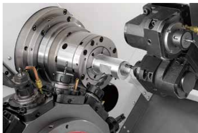
2基のタレットによる同時複合加工
