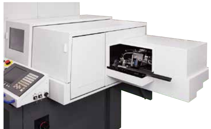
機械の右側面からブランクワークを供給
