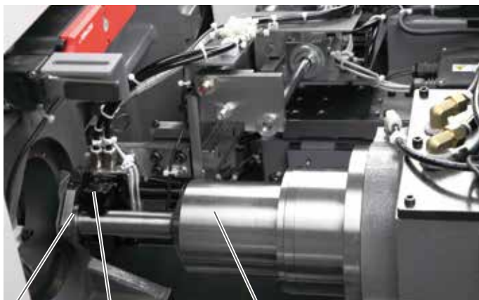
部品受け ワークハンドの爪 コレットチャック
