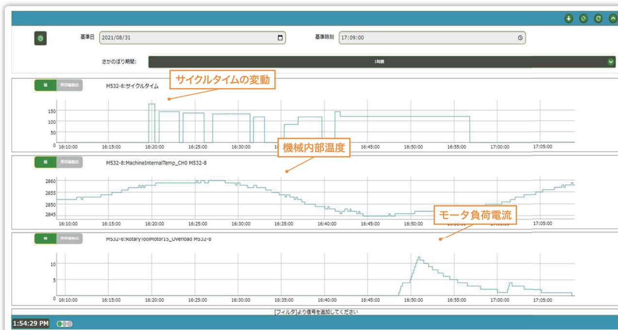
サイクルタイムや機械内部温度、各軸のサーボモータ負荷電流値などのアナログデータを最短500ms間隔でリアルタイムや履歴を表示します。例えば、サイクルタイムの変動を見ることで、オーバーライドが掛かった状態で生産されていないか確認することができます。
