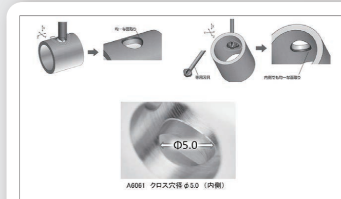
紹介記事の例 [シチズンマシナリーのオリジナルGコードオプション3D面取り機能]
