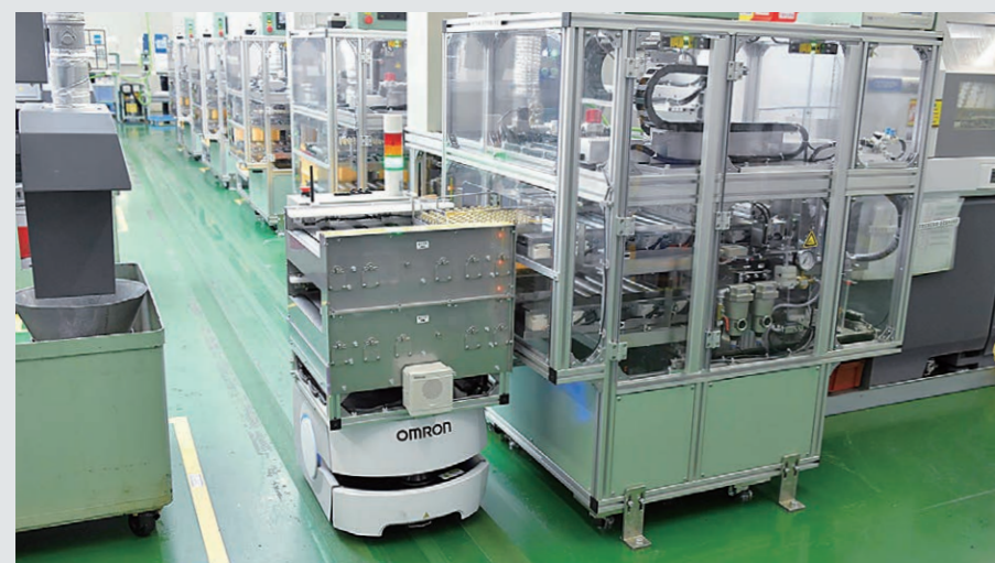
パレットに満杯になった測定済みの部品を自動で回収するAGV。この後、洗浄機へと搬送する
