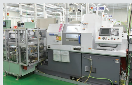
シンコムで精密加工された部品は左の測定工程に送られ厳しくチェックされる
