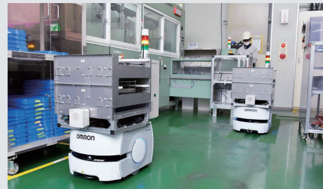
新たに構築した生産ラインの効率化に大きく貢献している2台のAGV
