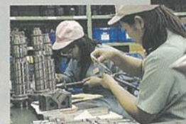
ボールネジ加工/組立/検査
