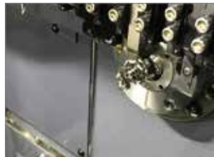
④切りくずが巻き付いている状態
