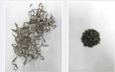
慣用切削による切屑 LFVによる切屑 [ 材質:SUS304 重さ:14.3g(同じ縮尺) ]
