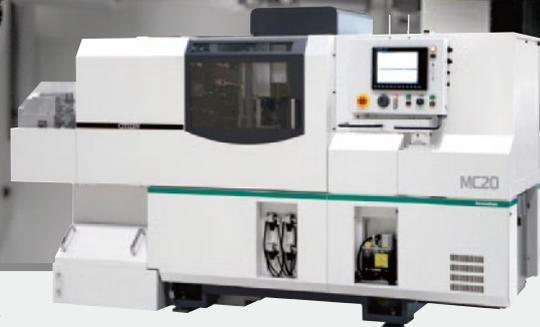
MC20は、例えば3台の単軸旋盤を連結している加工ラインを1台に集約することができるマシンです。この機械構成で、生産ラインの移設や変更の負荷を大きく軽減します。また、加工間ローダーを必要とせず、高精度に芯出しされた主軸同士でワークを受け渡すため、掴み替えによる加工精度低下を最小限に抑え、高速な受け渡しを実現しています。加工ワークを変更する場合でも、ハンドの爪交換とNCプログラムによる位置調整で対応することができ、対象ワークの変更にも容易に対応できます。
