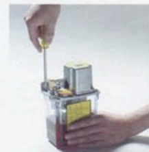
タンク上蓋の4隅のボルトをはずす
